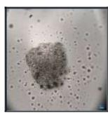
Figura 3.4. Calcita microcristalina con inclusiones de grafeno.
