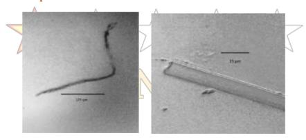
Figura. 3.1. Formas de cinta de compuesto de carbono de una muestra en Moderna 01. La primera imagen es de una muestra húmeda y a un bajo aumento. La segunda imagen es la de la misma muestra cuando está seca e incrustada en la solución a gran aumento.
