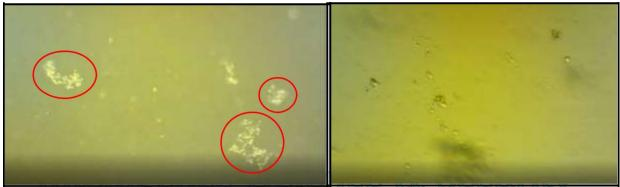
Figura 3.13. Hojas flotantes de material translúcido en una muestra humeda observadas con microscopio óptico. (b) El material detrítico asentado en el fondo de la placa. Las sombras del material flotante más claro pueden verse como figuras oscuras y nebulosas.
