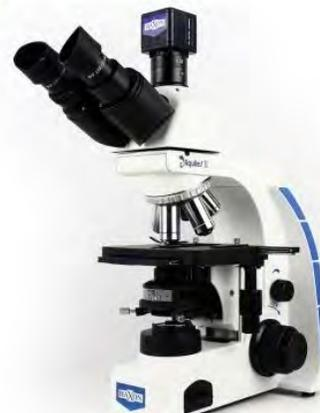
**Nota: No incluye la cámara, es el equipo básico para ir ampliando a posteriori con diferentes accesorios de contraste de fase campo oscuro de inmersión, fluorescencia, etc.**
